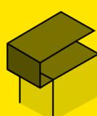
Dachaufstockung mit Auskragung
